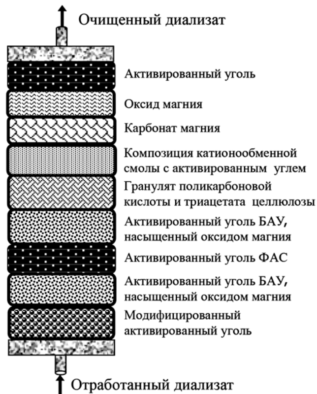
Рис. 2. Состав сорбционной колонки, используемой для элиминации из отработанного диализирующего раствора уремических метаболитов
