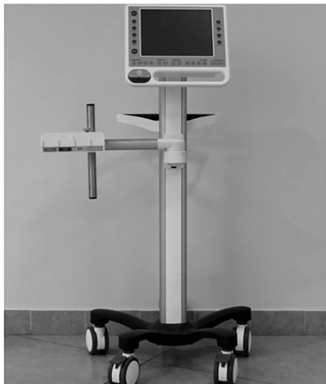
Рис. 1. Моноблок монитора краниоспинального комплайенса «Нейроком», установленный на мобильную стойку с ложементом-держателем датчиков физиологических давлений
