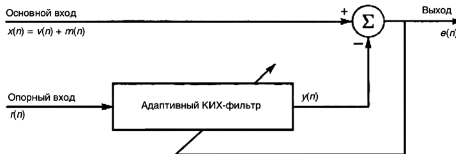
Рис. 1. Структурная схема адаптивного фильтра подавления шумов (пояснения – в тексте статьи)
