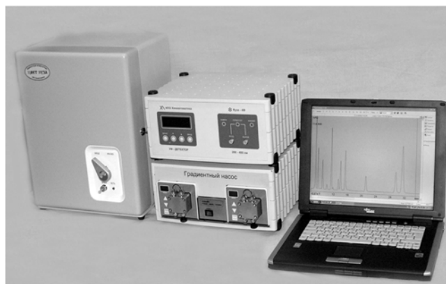
Рис. 1. Жидкостный хроматограф «ЦветЯуза» с амперометрическим детектором
