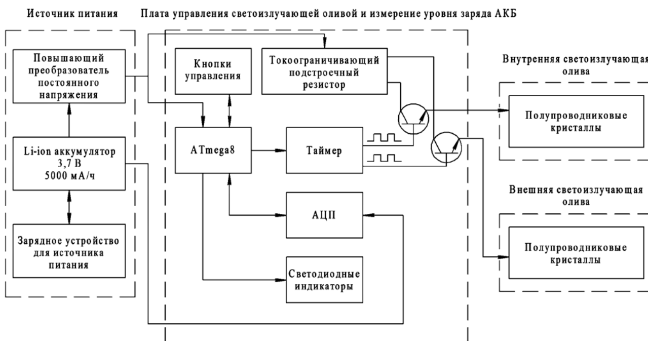
Рис. 1. Блок-схема устройства для диафаноскопии полых органов
