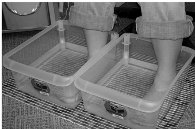
Рис. 2. Методика измерения суммарных потенциалов конечностей. Сзади слева видны измерительные электроды, контактирующие с конечностями через раствор NaCl
