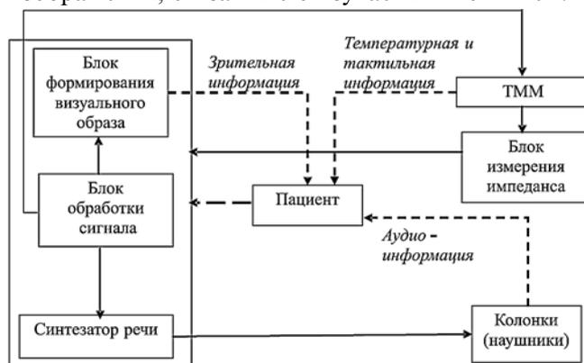
Рис. 9. Функциональная схема системы для восстановления ассоциативных функций речи методом формирования параллельных ассоциаций (ТММ – термомеханический модуль)
