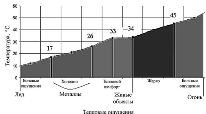
Рис. 8. Диапазон изменения температуры термомеханического модуля в соответствии с предложенной классификацией температурных ощущений
