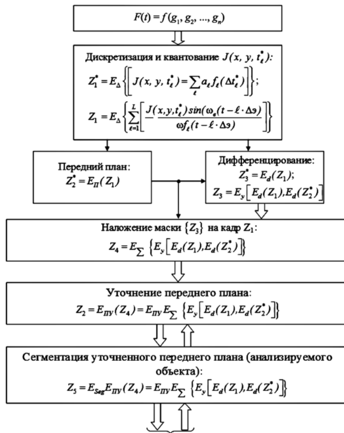
Рис. 4. Уточненная функциональная модель первичной (предварительной) обработки изображения: \omega_b – верхняя частота амплитудного спектра изображения; \Delta_{\theta} – эталонная измерительная величина
