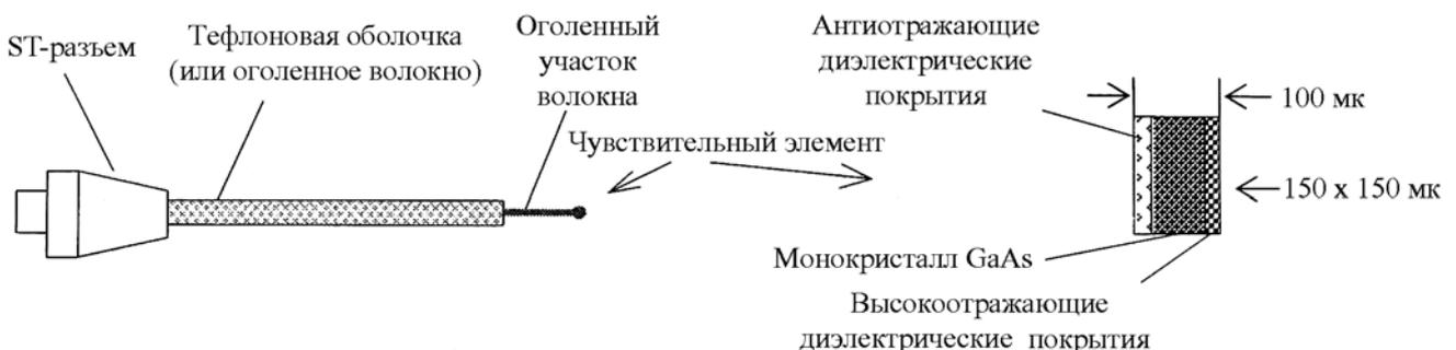
Рис. 2. ВОД температуры ОТГ-М
