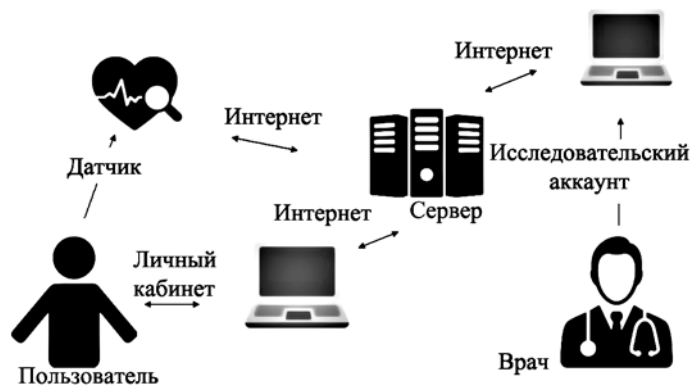
Рис. 2. Схема работы веб-ориентированного сервера
