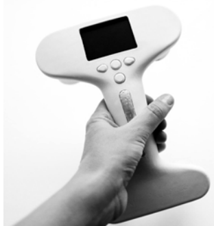
Рис. 1. Внешний вид портативного кардиографа «ЭКГ-ЭКСПРЕСС»
