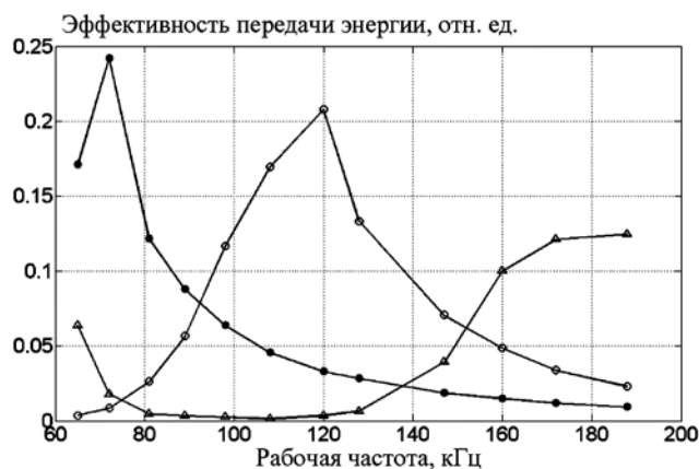
Рис. 6. Зависимость эффективности передачи энергии от рабочей частоты системы для различных значений C_{res1} и C_{res2} : 125 и 132 нФ (●), 45 и 48 нФ (○), 18 и 19 нФ (Δ)
