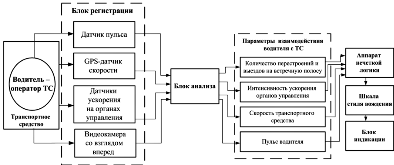
Рис. 1. Структурная схема системы поддержки водителя ТС
