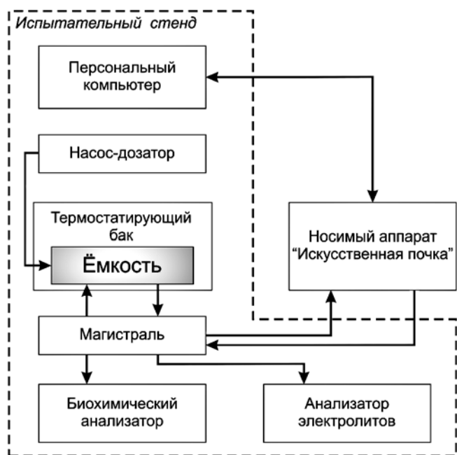
Рис. 4. Функциональная схема стенда проверки характеристик аппарата
