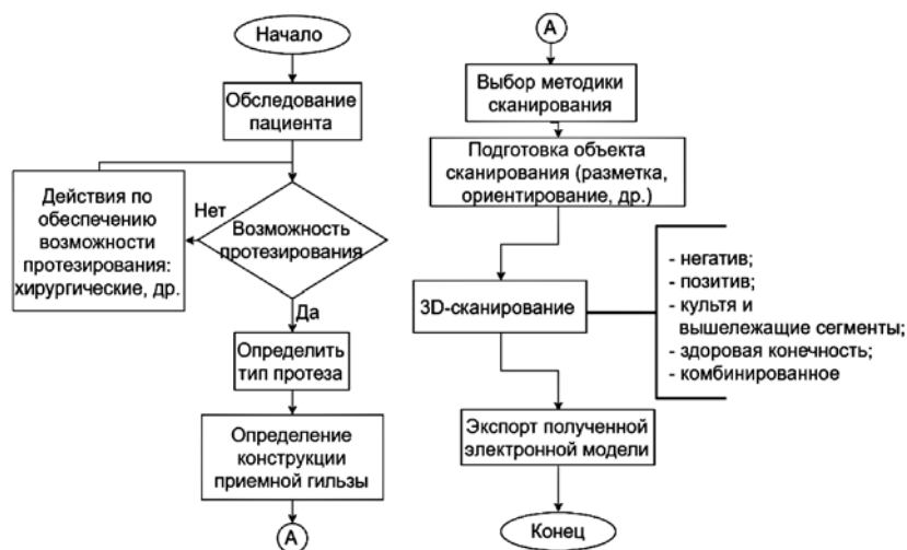
Рис. 1. Блок-схема технологического процесса 3D-сканирования при протезировании верхних конечностей
