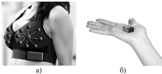
Рис. 3. Диагностический бюстгалтер (а); миниатюрный радиотермометр (б)
