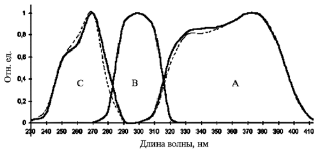
Рис. 1а. Относительная спектральная чувствительность ТКА-АВС в трех диапазонах С, В и А, отмеченных на рисунке соответствующими литерами
