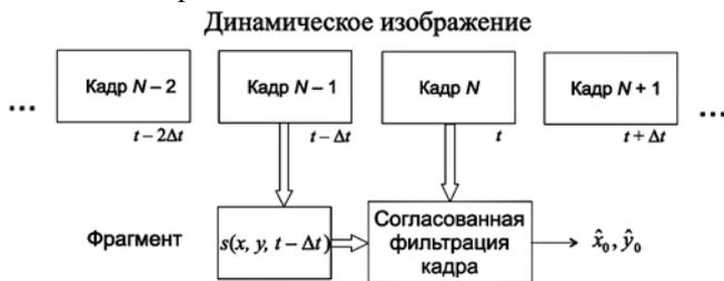
Рис. 1. Структура системы обработки динамических изображений
