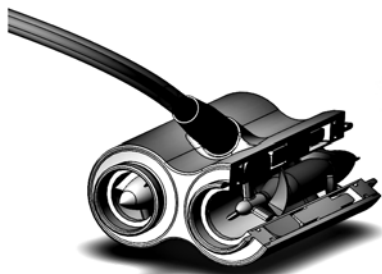
Рис. 4. Имплантируемый модуль ПИС-МИЭТ, состоящий из двух роторных насосов постоянного потока
