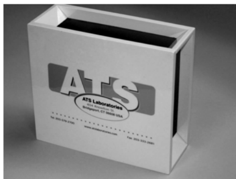
Рис. 1. Ультразвуковой фантом «ATS Laboratories Model 539» на полиуретановой основе
