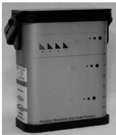
Рис. 2. Ультразвуковой фантом «Gammex 405 GSX LE» на водогелиевой основе
