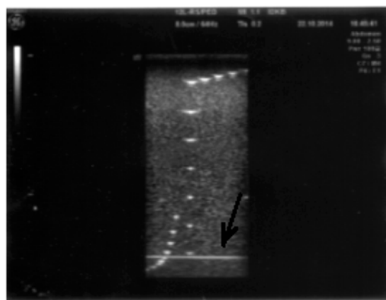
Рис. 5. Изображения мишеней фантома «ATS Laboratories Model 539», полученные на конвексном (слева) и линейном (справа) датчиках, свидетельствующие о неисправности работы прибора
