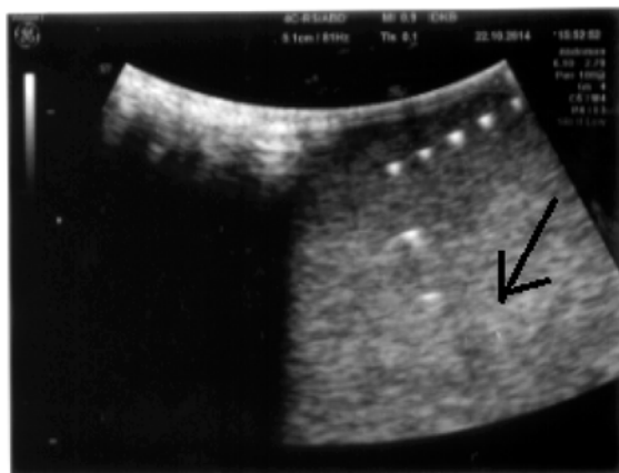
Рис. 5. Изображения мишеней фантома «ATS Laboratories Model 539», полученные на конвексном (слева) и линейном (справа) датчиках, свидетельствующие о неисправности работы прибора
