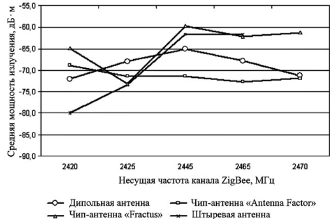
Рис. 1. Мощность принимаемого сигнала на расстоянии 5 м от источника для различных типов антенн
