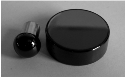
Рис. 1. Образцы из сплава CoCrMo с нанесенным алмазоподобным покрытием
