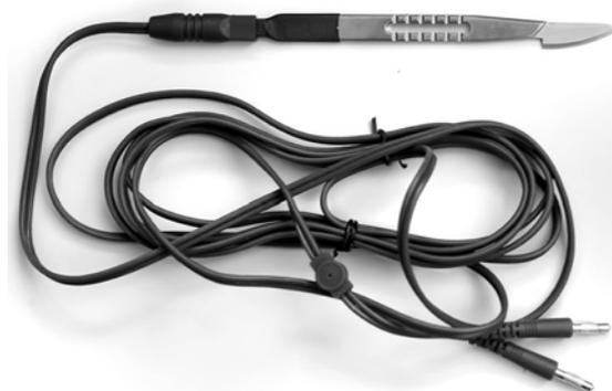
Рис. 4. Экспериментальный образец биполярного скальпеля
