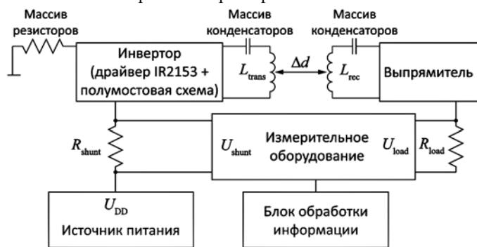
Рис. 1. Схема эксперимента
