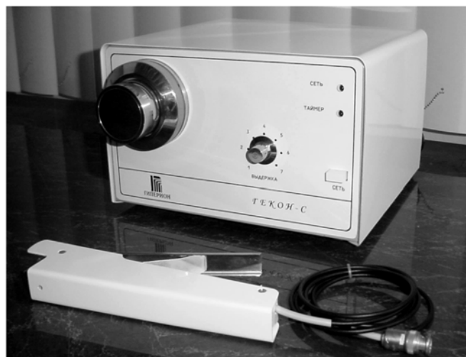
Рис. 2. Внешний вид автоматизированного устройства для герметизации трубок полимерных контейнеров для заготовки и хранения крови
