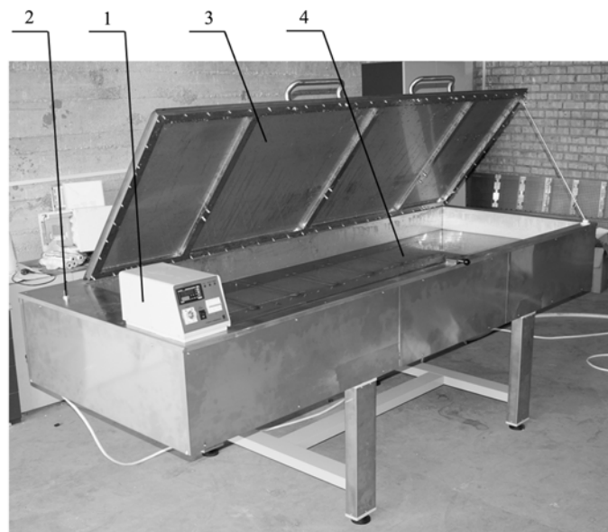
Рис. 2. Базовая конструкция устройства для инактивирования вирусов при термической обработке флаконов с препаратами крови: 1 – блок управления; 2 – фитинг для подключения компрессора; 3 – крышка резервуара; 4 – резервуар
