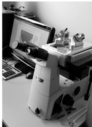
Рис. 1. Сканирующий зондовый микроскоп «ФемтоСканХi» на базе оптического инвертированного микроскопа «Nikon Ti-U»
