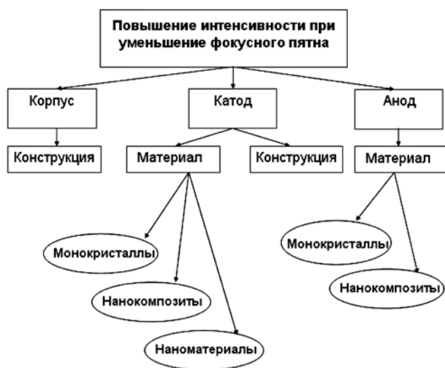
Рис. 1. Концептуальная схема разработки высокоэффективных рентгеновских трубок
