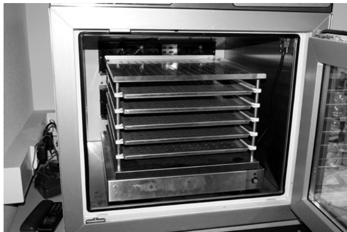
Рис. 2. Устройство безопасного хранения тромбоцитосодержащих трансфузионных сред с установленным в нем тромбомиксером
