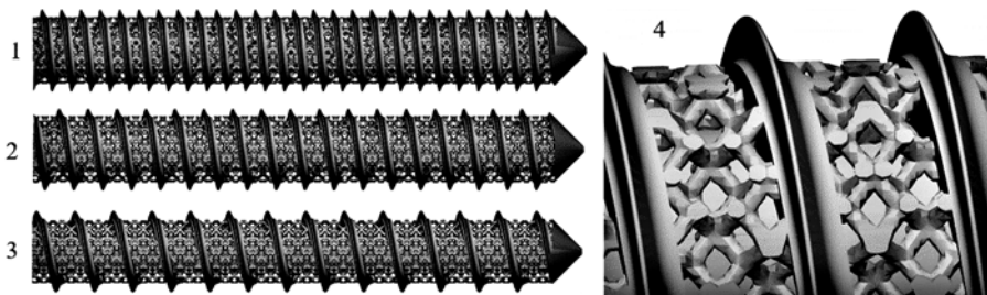
Рис. 2. Анализируемые винты с резьбой и ячеистой структурой: 1 – винт с шагом резьбы 7 мм; 2 – винт с шагом резьбы 5,25 мм; 3 – винт с шагом резьбы 3,5 мм; 4 – вид на ячеистую структуру и резьбу
