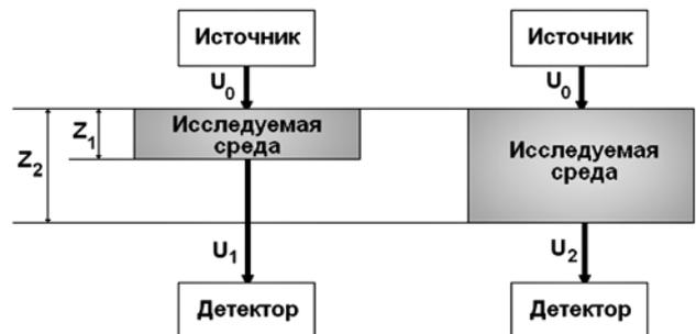
Рис. 1. Схема измерений интенсивности излучения для метода определения коэффициента поглощения и коэффициента рассеяния биологической СРС:  $U_0$  – интенсивность излучения источника;  $U_1, U_2$  – интенсивность излучения, зарегистрированная детектором для значений толщины рассеивающего слоя  $z_1$  и  $z_2$  соответственно
