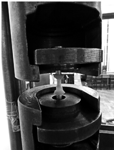
Рис. 2. Образец Estelite Universal Flow Medium оттенка А2 в разрывной камере машины ИМ-4Р
