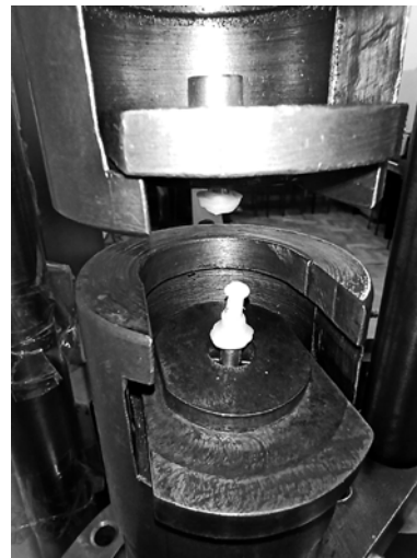
Рис. 3. Образец Estelite Universal Flow Medium оттенка А2 после испытаний
