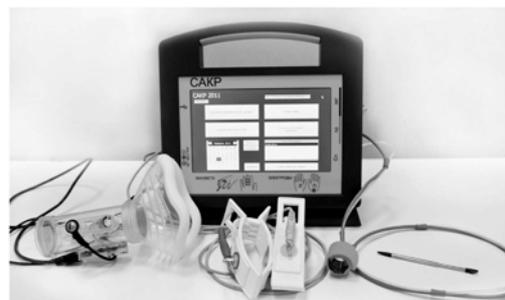
Рис. 2. Электронно-пневматический блок САКР-2 с ультразвуковым спирометрическим датчиком, пальцевой манжетой и ЭКГ-электродами
