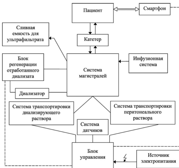
Рис. 2. Функциональная схема аппарата внепочечного очищения крови
