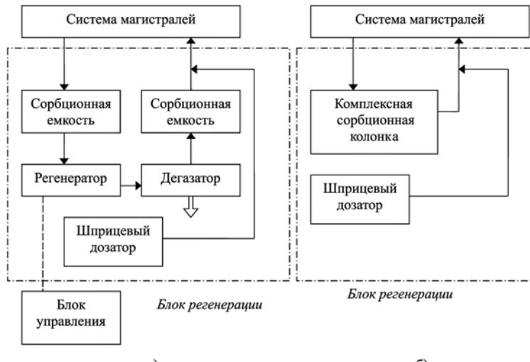
Рис. 3. Схема блока регенерации отработанного диализата с электрохимическим методом разложения мочевины (а); с ферментативным методом разложения (б)
