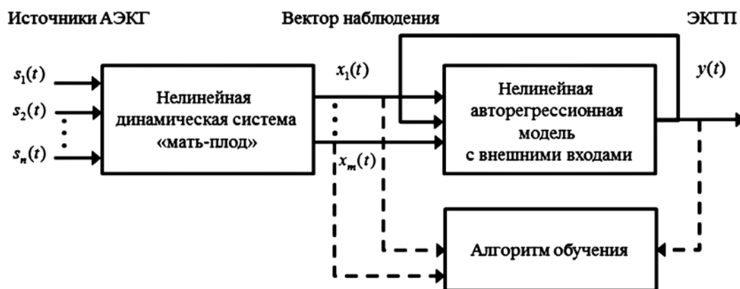
Рис. 1. Блок-схема обработки сигналов для выделения источника по данным регистрации смеси на выходе неизвестной системы
