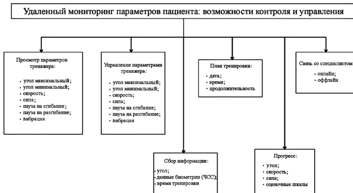
Рис. 1. Программный модуль дистанционной работы аппарата «Пульсар-К»
