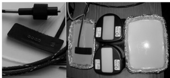
Рис. 1. Оптоволоконный многодистантный датчик, стандартные калибровочные блоки («ISS, Inc.», США) и изготовленные фантомы
