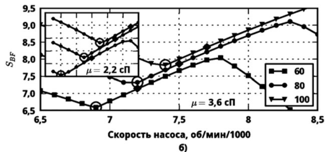
Рис. 2. Зависимость S_{BF} от скорости насоса при вариации сократительной способности левого желудочка сердца (а), частоты сердечных сокращений (б) и двух величинах вязкости крови \mu
