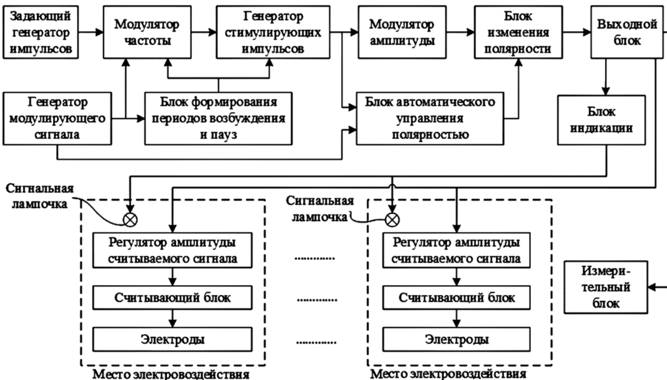
Рис. 3. Функциональная схема аппарата для многоканального электростимуляционного воздействия
