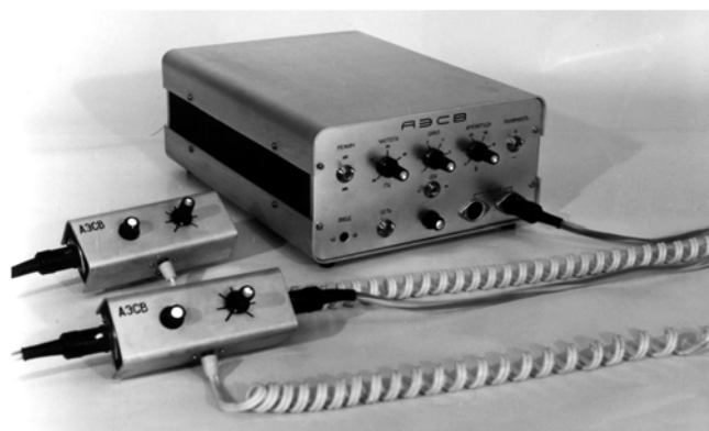
Рис. 1. Внешний вид устройства для многоканального электростимуляционного воздействия на нервно-мышечную систему человека
