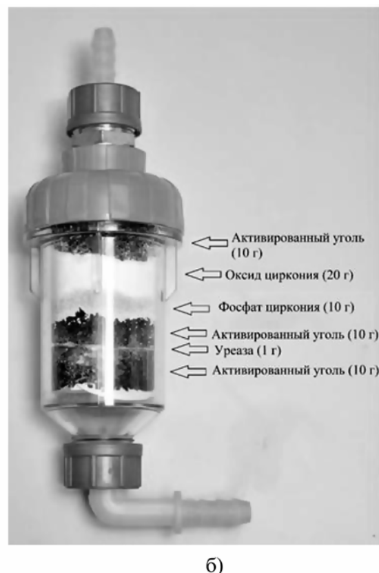
Рис. 2. Схема эксперимента для исследования гидролиза мочевины (а) и структура комплексной сорбционной колонки (б)
