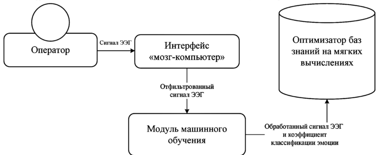
Рис. 1. Структурная схема обработки сигнала ЭЭГ с применением машинного обучения и ОБЗ на мягких вычислениях
