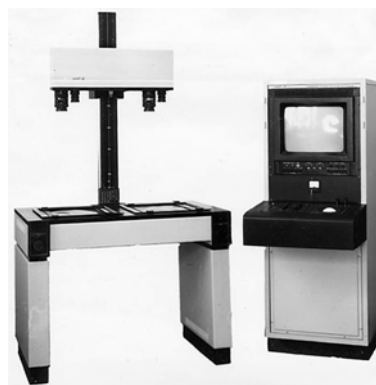
Рис. 1. Установка для анализа рентгенограмм УАР-2
