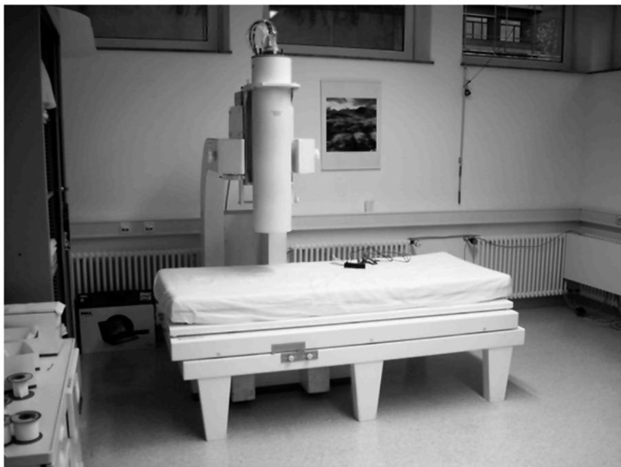
Рис. 1. Практическая реализация базового модуля МКГ-комплекса с девятью каналами регистрации МКГ, прошедшего доклинические испытания в поликлинике № 3 ЦКБ РАН и клинике университета г. Тюбинген, Германия
