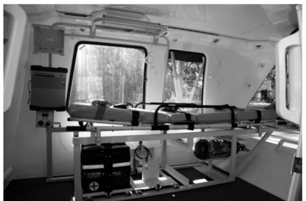
Рис. 4. Модуль медицинский вертолетный, разработанный ООО «Пневмоприбор», в салоне вертолета Ка-226 (опытный образец)
