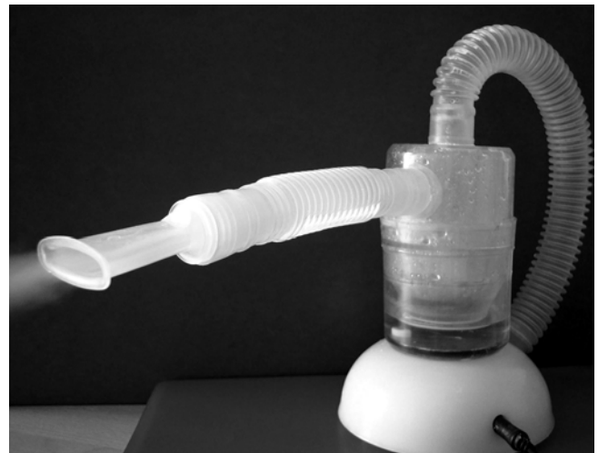
Рис. 1. Общий вид ингалятора «Бриз-1» со сменной щелевой насадкой для направленной подачи аэрозольного облака микрочастиц антисептика
