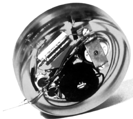
Рис. 1. Первый имплантируемый ЭКС «Siemens-Elema» (Германия)
